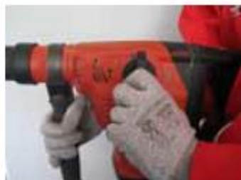
Réglage de l'orientation du burin
