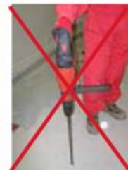
Toujours tenir la machine à deux mains
