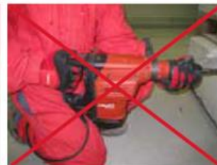
Ne jamais tenir la machine par le mandrin ou la mèche
