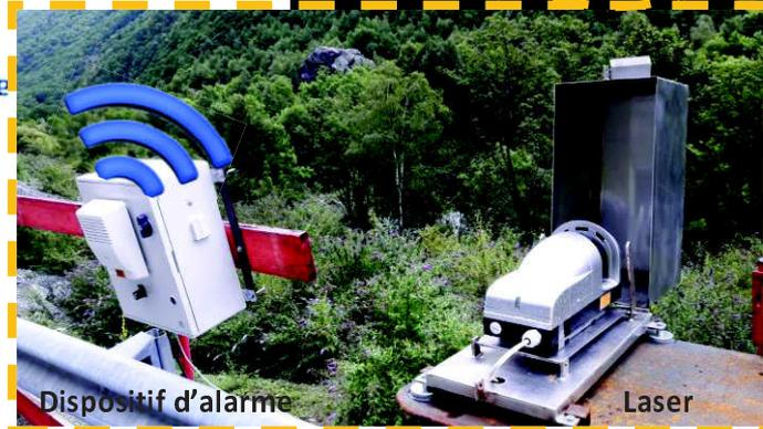
**Caractéristiques** : Il s'agit de matériel de détection standard, alimenté en 220V, fiable, facile d'installation, transportable et présentant un coût approximatif (achat / fonctionnement) de 4500€.
