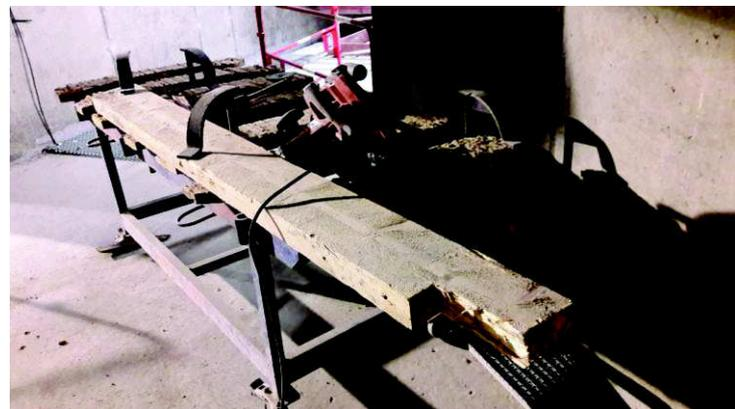
Exemple d'établi avec serre-joints de maintien
