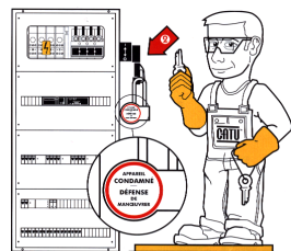
2 - Condamner les organes de séparation en position ouverte.
