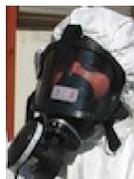
**Masque à ventilation assistée TM3P, cagoule ou heaume à ventilation assistée TH3P ; ou masque isolant à adduction d'air, à pression positive, avec débit réglable à la demande** pour les interventions sur matériaux émissifs tels que flocage ou calorifugeage.
