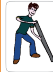
* Bloquer l'extrémité de la poutre pour l'empêcher de glisser
